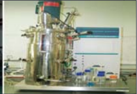
شکل ۱۰: استفاده از بیوراکتور به منظور تولید متابولیت‌های ثانویه
